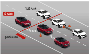
Anti-Lock Braking System & Electronic Brake Distribution (ABS & EBD) ระบบป้องกันล้อล็อกและระบบกระจายแรงเบรก
