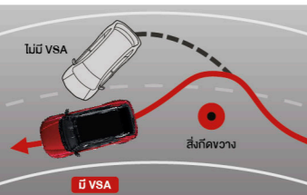
Vehicle Stability Assist (VSA) ระบบช่วยควบคุมการทรงตัวขณะเข้าโค้ง
