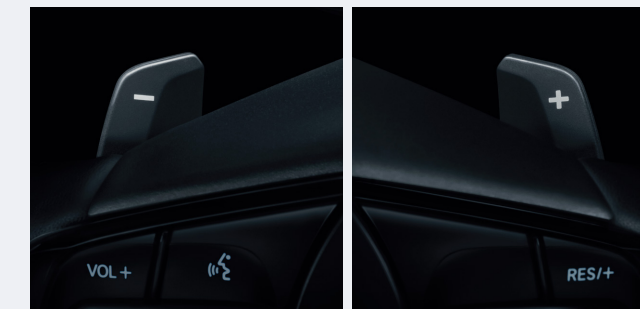
Deceleration Paddle Selectors ระบบช่วยชะลอความเร็วรถที่พวงมาลัย
