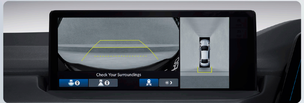
Multi-view Camera System (MVCS) ระบบกล้องมองภาพรอบทิศทาง
