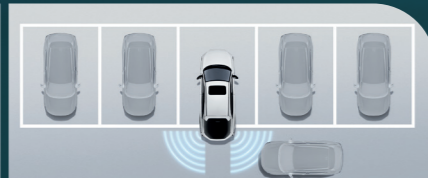
CROSS TRAFFIC MONITOR (CTM) ระบบเตือนเมื่อมีรถเคลื่อนผ่านขณะถอย
